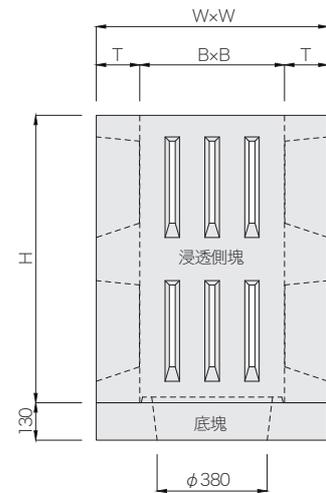
TYS 中型浸透柵500 縁塊・側塊 規格寸法表
