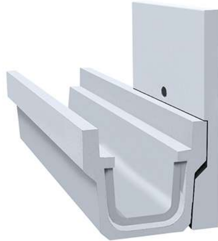
布設標準構造図 (基礎ブロック使用)
