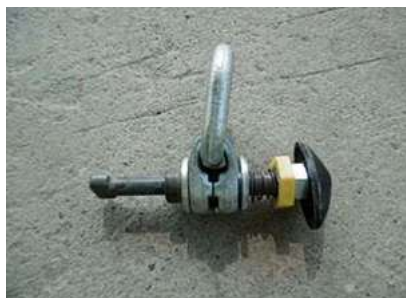
①専用吊具の取付け
