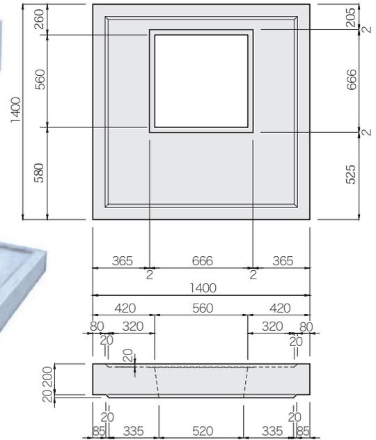
TYS 大型浸透柵1000 上部側塊 規格寸法表
