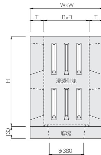
TYS中型浸透柵500 縁塊・側塊 規格寸法表
