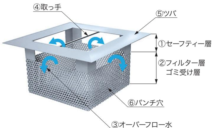
ダストバスケットは溶融亜鉛メッキ仕上げですので、サビに強く耐久性があります。普段から泥水の入る浸透施設は透水シートが目詰まりして浸透能力が低下してしまうので、このダストバスケットの使用をお勧めします。
