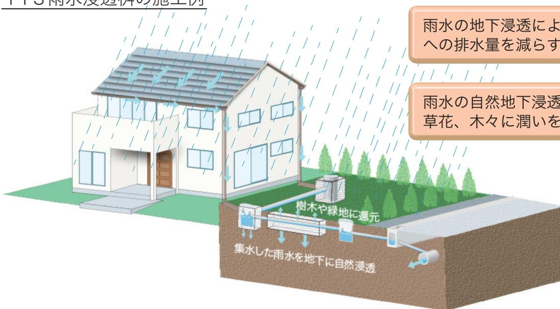
雨水の地下浸透により流末河川への排水量を減らす
