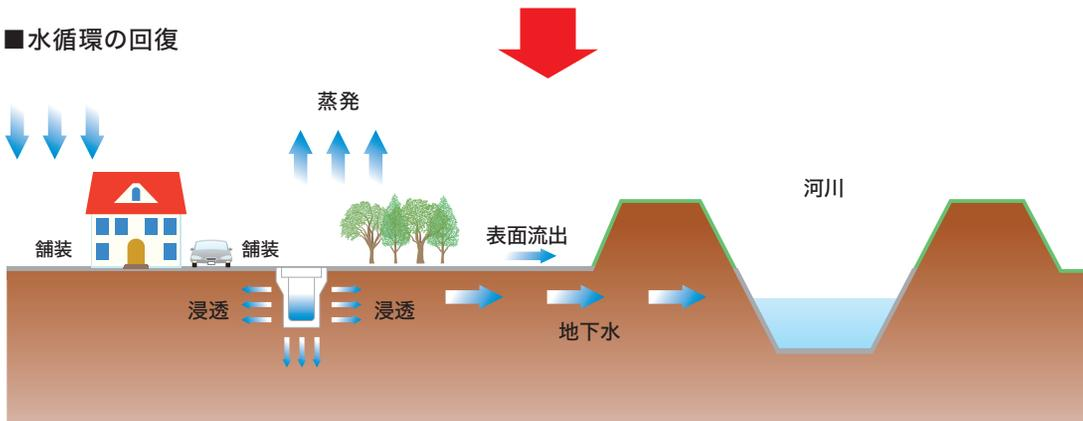
浸透側溝を設置した場合、水循環サイクルを復元
