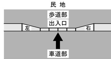
歩車道境界ブロック斜の左と右の区分は上図のように出入口を車道側から歩道側に向かって見て左側に使用する斜を左、右側に使用する斜を右と区分してください。
